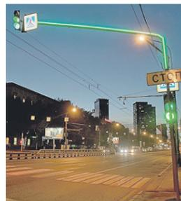
Москвы. Это позволяет привлечь внимание водителей издалека даже в непогоду. Теперь зеленым, желтым и красным светом загорается не только сигнал светофора на пешеходном переходе, но и опора, на которой он установлен. Дополнительную подсветку получили и расположенные рядом дорожные знаки перехода. Всего в 2018 году подобным образом было оснащено 59 светофоров. В районе Черемушки такие светофоры появились на Нахимовском проспекте, возле дома 30 и рядом с домом 42 по Профсоюзной улице.
